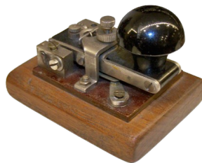
Manipulateur Morse miniature (origine Anglaise WWII)
